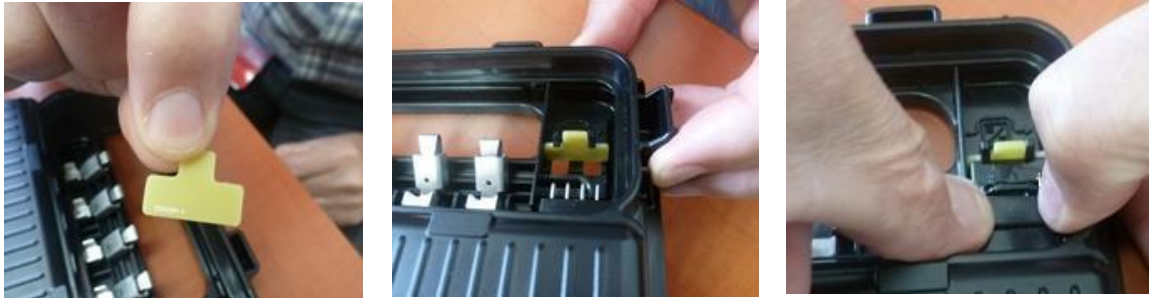
Abbildung 7 – Einsetzen des Kunststoffdistanzhalters und des Bypass Verbinders
