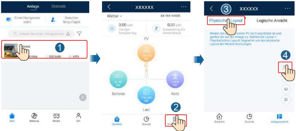
2. Melden Sie sich bei <https://intl.fusionsolar.huawei.com> an, um auf die Web-UI des FusionSolar Smart PV-Managementsystems zuzugreifen. Klicken Sie auf der **Start** auf den Anlagennamen, um die Anlagenseite aufzurufen. Wählen Sie **Layout**. Wählen Sie **Layout erstellen** und erstellen Sie nach Aufforderung eine physische Layoutvorlage. Sie können ein Layout des physischen Standorts auch manuell erstellen.
