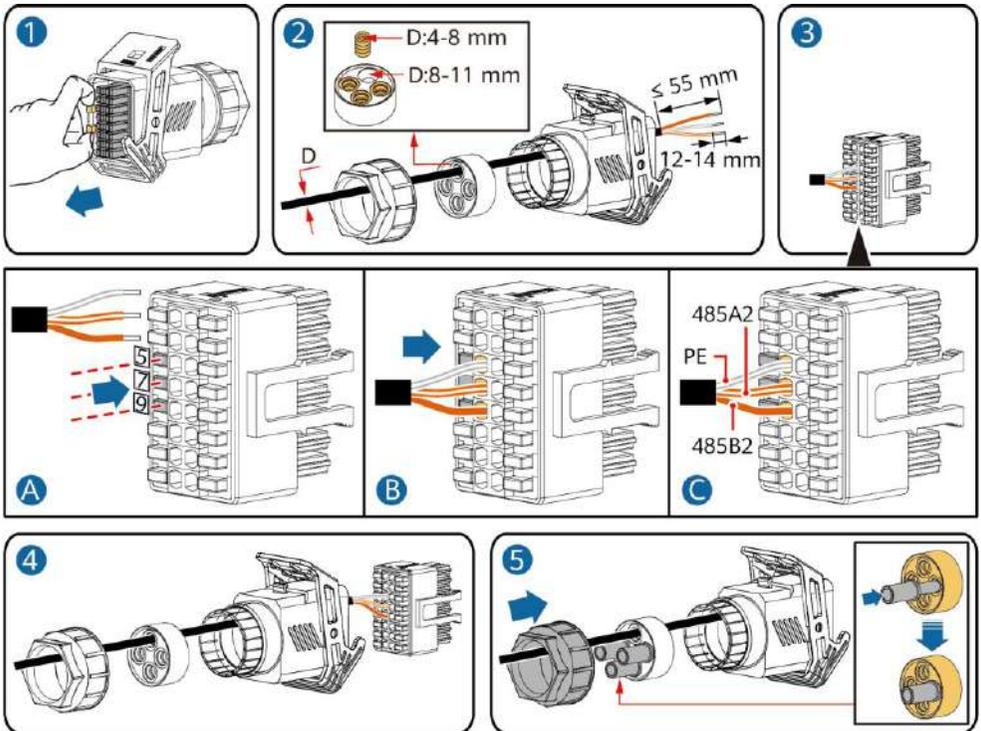
2. Verbinden Sie den Signalkabelverbinder mit dem Kommunikationsport.
