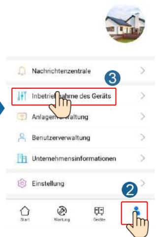
2. Stellen Sie eine Verbindung zum WLAN des Solarwechselrichters her und melden Sie sich als **Installer** an, um auf den Bildschirm „Inbetriebnahme des Geräts“ zuzugreifen.
