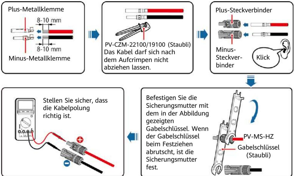
2. Schließen Sie die DC-Eingangsstromkabel an.
