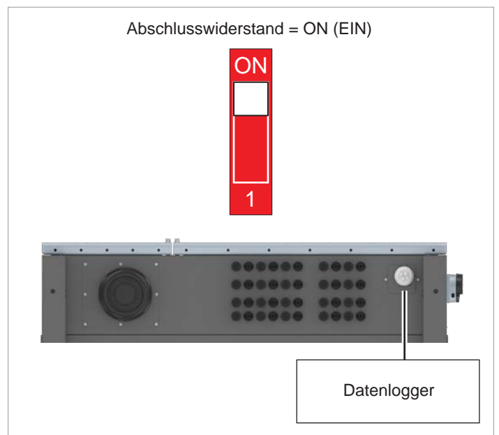
Abb. 6.3: RS485: Anschlussplan für einen einzelnen Wechselrichter
