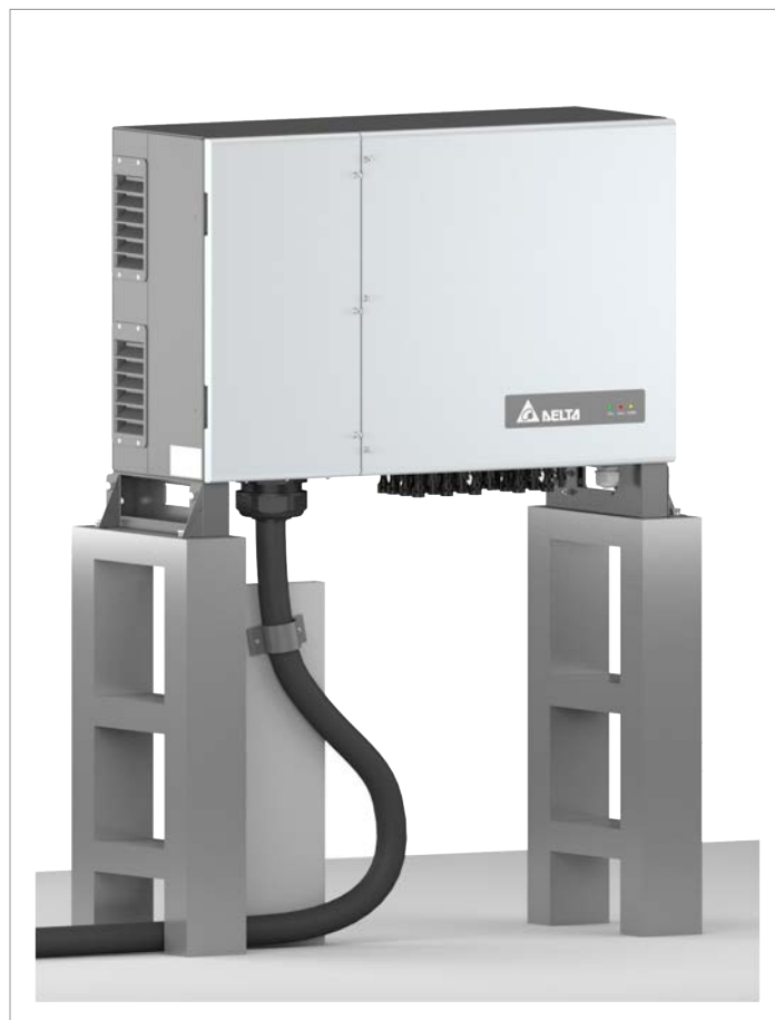
Abb. 5.2: Empfohlene Zuführung des AC-Kabels mit Zugentlastung bei Bodenmontage
